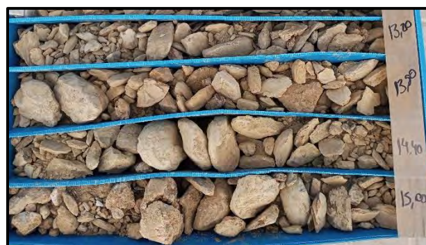
A l'esquerra, aspecte de la roca de la capa B més sana, amb fragments de roca continus, on s'observa la seva densa foliació. En tot cas, a la dreta es mostra l'aspecte més alterat, que en la perforació es recupera disgregat en forma de graves.
