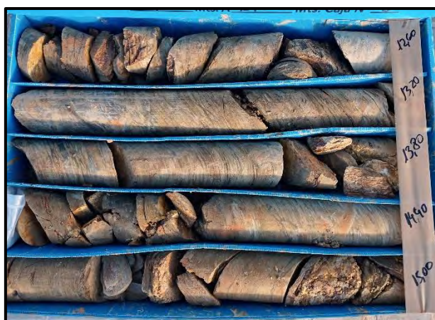
A l'esquerra, aspecte de la roca de la capa B més sana, amb fragments de roca continus, on s'observa la seva densa foliació. En tot cas, a la dreta es mostra l'aspecte més alterat, que en la perforació es recupera disgregat en forma de graves.
