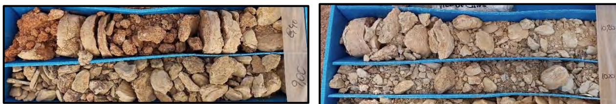
Aspecte dels materials de la capa A2, que constitueixen un sòl mixte entre argiles ocres i sorres amb grava de pissarra i quars.
